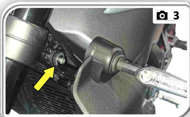
**IT** Rimuovere lo scarico originale svitando gli attacchi del radiatore tramite la staffa in foto (1) e le 2 viti laterali in foto (2) e (3). Una volta istallato l'impianto Mivv, rimontare il radiatore.
